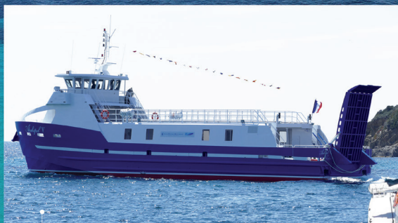
CARGO SHIP 30m Archipel V NAVIRE TRANSBORDEUR 30 M FR T ROULANT ET VRAC 58 T NAVIRE CLASS  BUREAU VERITAS 1 X HULL • MACH RO-RO CARGO SHIP COASTAL AREA
